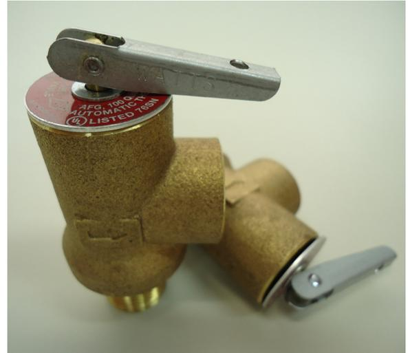
**Nota:** a pressão de trabalho indica o range funcional da válvula durante as manobras automáticas de abertura e fechamento. O range de abertura da válvula está entre 90% a 105% da pressão nominal, acontecendo em qualquer ponto deste range. O fechamento acontece a 80% da pressão nominal.
